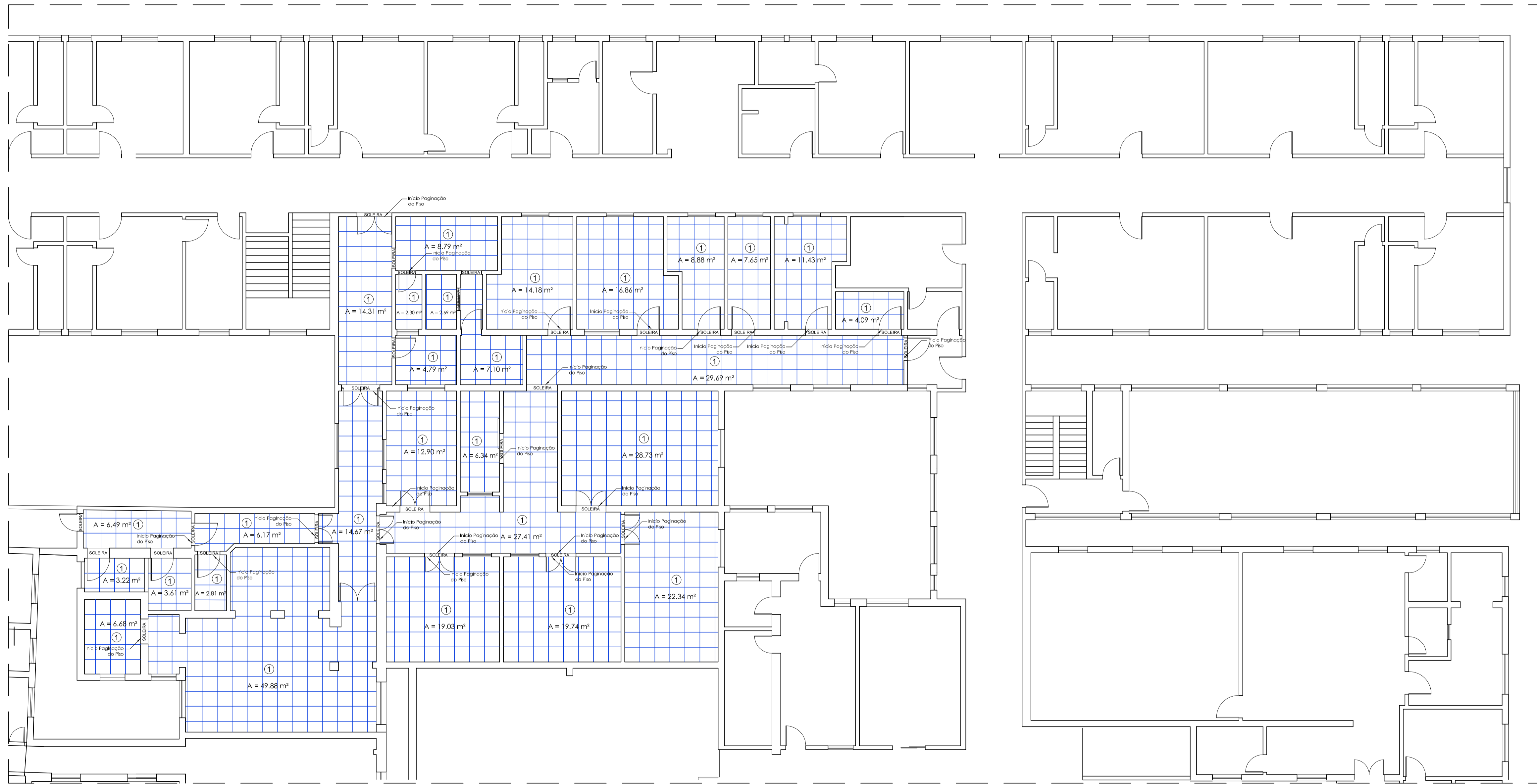
PLANTA BAIXA 1º PISO (PAGINAÇÃO DE PISO) A= 362.98m 2 + 10% = 399.27 m 2 escala 1:100
